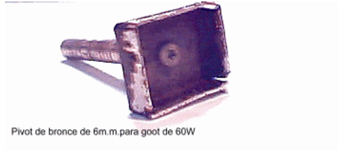
Pivot de bronce de 6 mm para soldador o cautín de 60W, con punta de 4 lados con tornillo de sujeción
